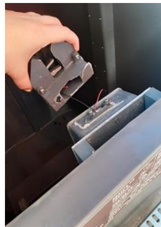
Figura 11 Cerradura abierta y bloqueada, cerradura rota y rotura anclaje
